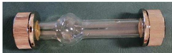
ensanchamiento del tubo, realizado para alojar el aire que se queda en el interior del tubo al rellenarlo, y de esta forma no interfiere cuando pasa la luz por la muestra.
